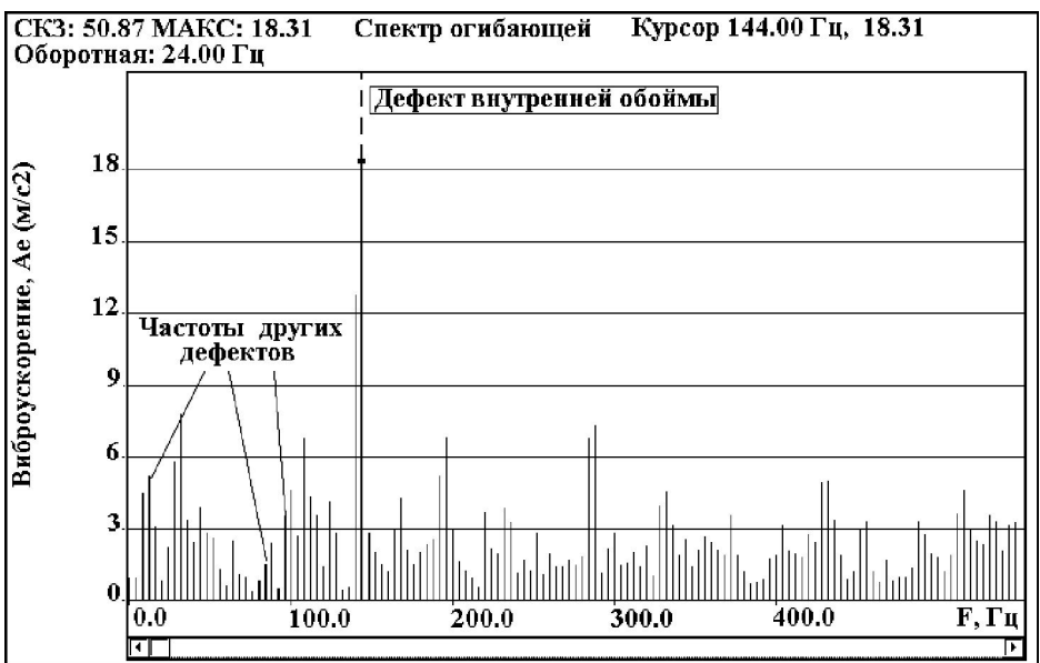
Рис. 2. Амплитудно-частотный спектр огибающей виброускорения подшипника качения с дефектами внутренней обоймы
