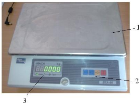
Рис. 4. Електроні лабораторні технічні ваги ВТА-60: 1 – звішувальне деко; 2 – панель калібрування; 3 – індикаторний дисплей
