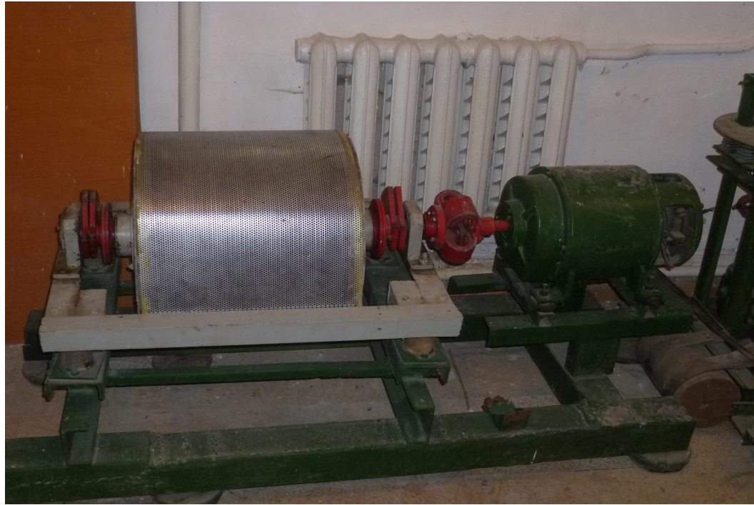
Рис. 1. Вібраційна машина з комбінованим механічним вібробудувачем для сушіння зерна
