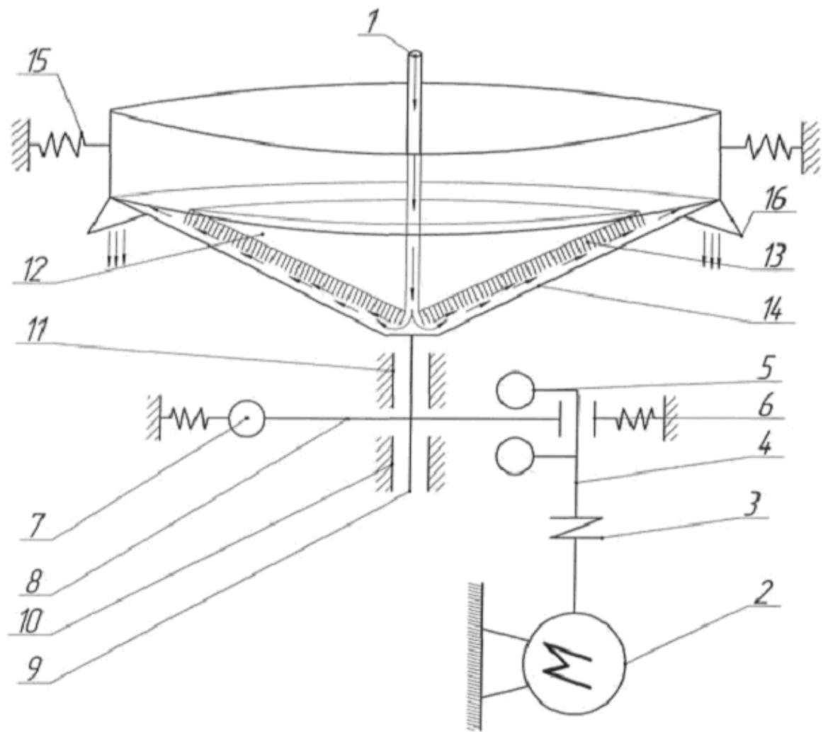
Корисна модель належить до вібраційного устаткування для лущення, шліфування та шеретування зерно-круп'яної сировини при виробництві крупів, комбікормів, підготовці зерна до помелу і може бути застосована на круп'яних та комбікормових заводах сільськогосподарського виробництва.
