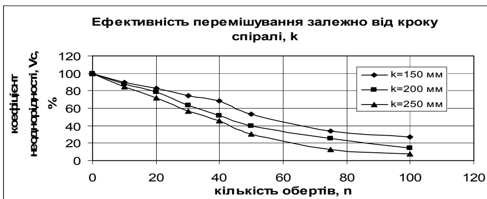
Рис. 4 Ефективність перемішування сипкого матеріалу залежно від кроку спіралі і кількості обертів
