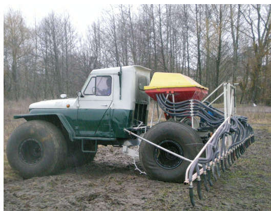
Рис. 1. Надлегкий мобільний енергетичний засіб з технологічними модулями:
