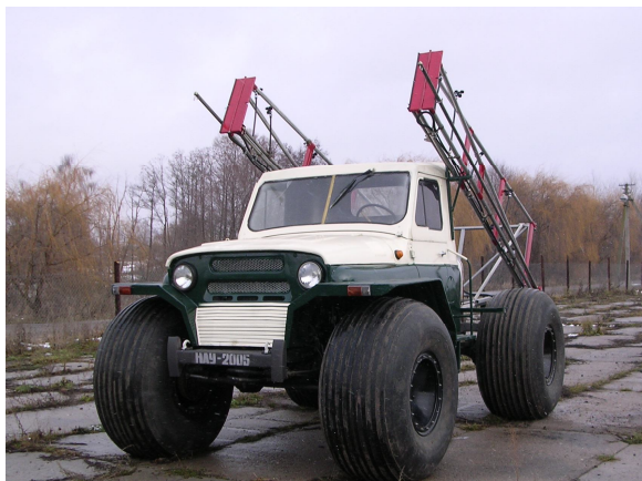
Рис. 1. Надлегкий мобільний енергетичний засіб з технологічними модулями:
