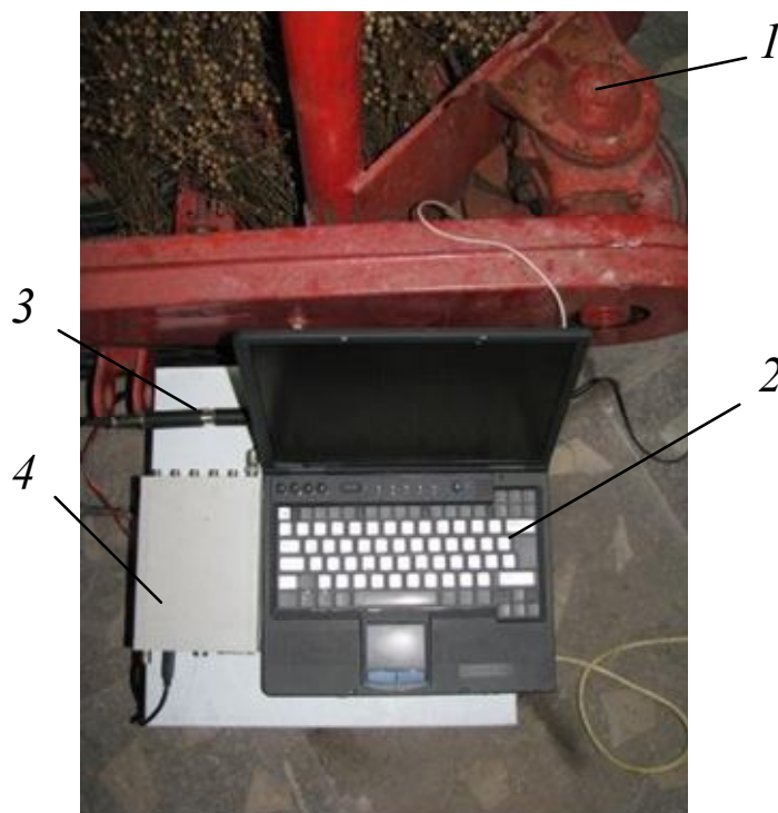
Рис. 2. Вимірювання крутного моменту: 1 – шків з встановленим датчиком крутного моменту; 2 – персональний комп'ютер; 3 – підсилювач; 4 – цифровий осцилограф USB Autoscope III.
