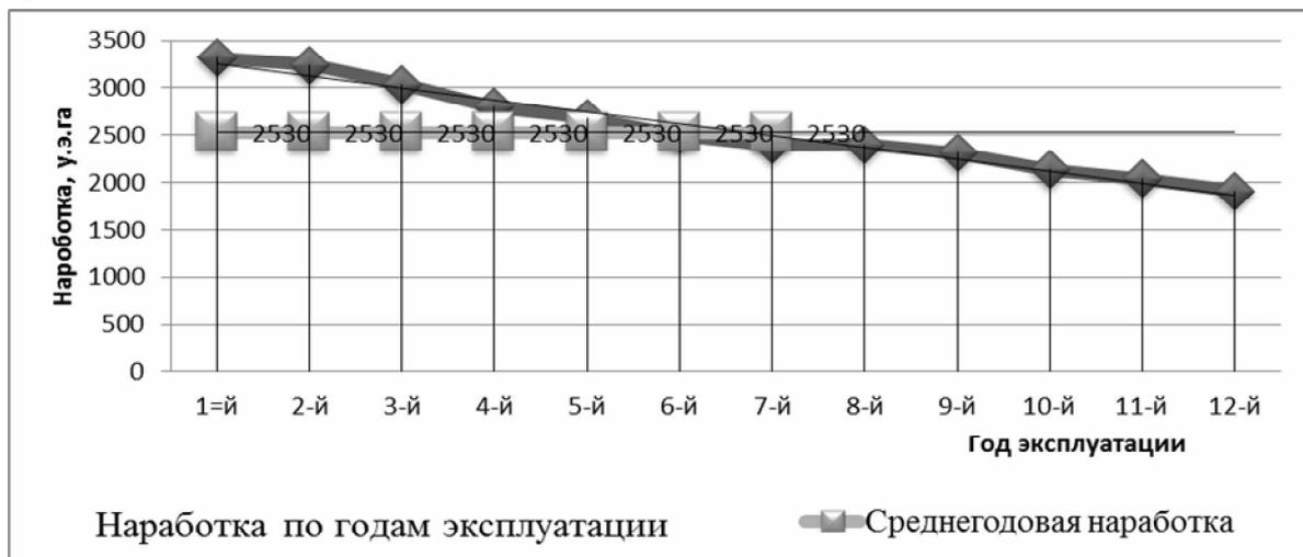
**Рис. 3. Динамика годовой наработки на трактор**
