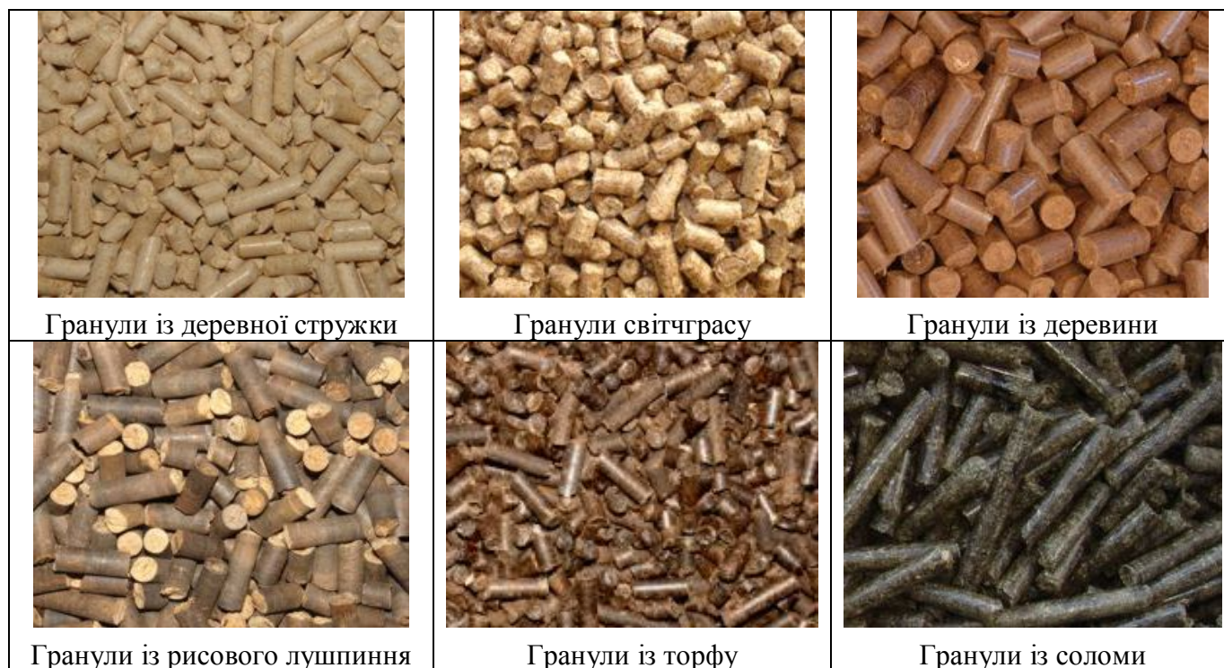
Рис. 2. Паливні гранули із різних видів сировини
