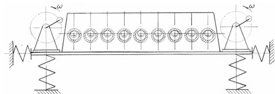
Рис. 1. Кинематическая схема классификатора
