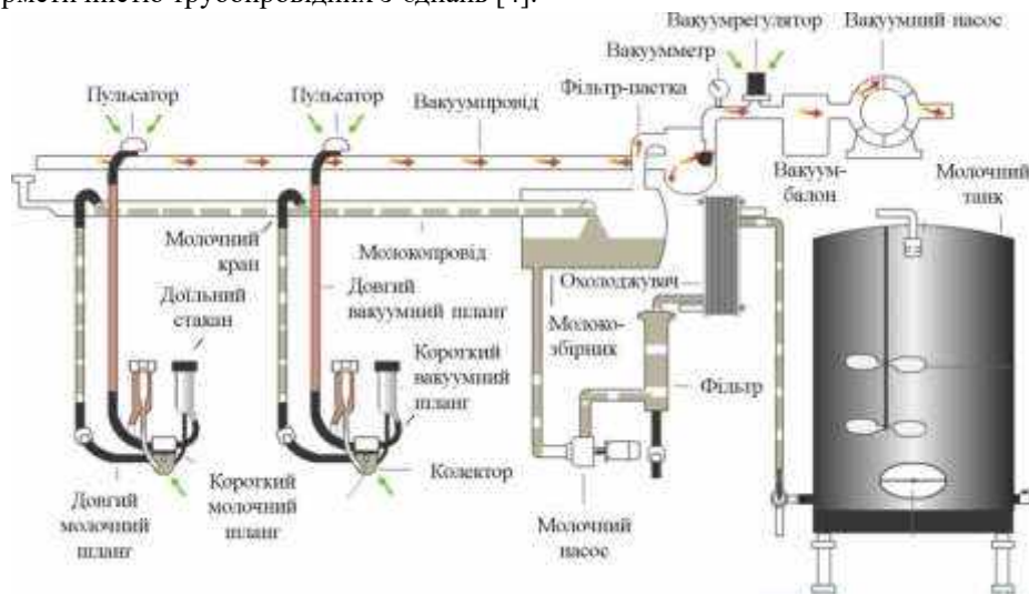
Рис. 3. Загальна схема доїльної установки
