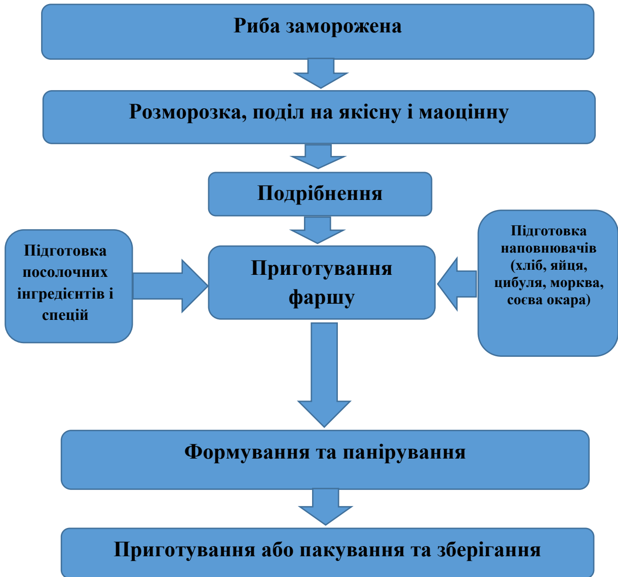
Рис. 5.1 Технологічна схема виробництва комбінованих риборослинних фаршевих композицій.
