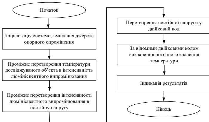
Рисунок 4.10 – Узагальнена блок-схема алгоритму реалізації люмінофорного методу вимірювання температури полюсних обмоток
