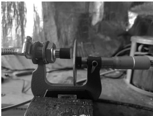
Рисунок 5.4 – Зовнішній вигляд дослідної установки для визначення метрологічних характеристик модернізованого накладного трансформаторного ВВП
