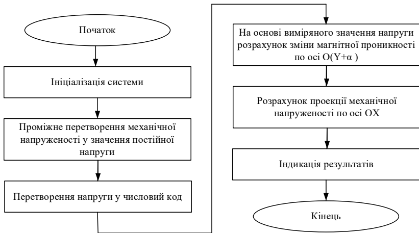
Рисунок 4.11 – Алгоритм реалізації магнітопружного методу вимірювання механічної напруженості феромагнітних конструкцій
