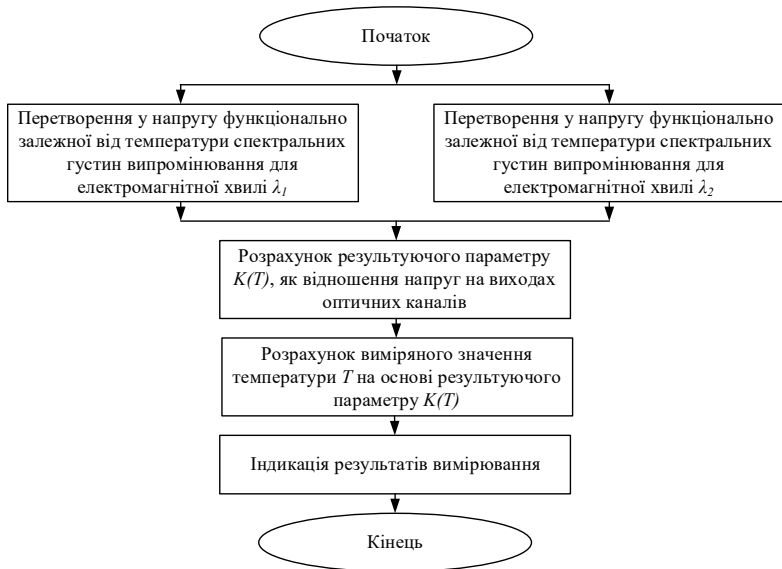
Рисунок 3.1 – Узагальнена блок-схема алгоритму реалізації біспектрального методу вимірювання температури полюсних обмоток обертових електричних машин
