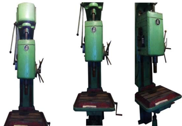
Рис. 2. Вертикально-свердлильний верстат 2А-135 для проведення фізичного моделювання процесу ШО
