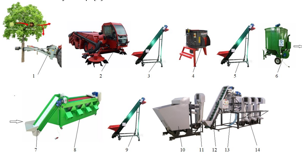
1 – гідравлічний струшувач VNB-D-E-F; 2 – комбайн для збирання горіхів R23; 3, 5, 7, 9, 12 – підйомні похилі конвєсери з гофробортом; 4 – обладнання для очищення горіхів від навколоплідника N40; 6 – сушарка; 8 – калібратор волоських горіхів Kadioglu Twist 1400; 10 – конусний горіхокол; 11 – аспіраційна колона відокремлення шкаралупи; 13 – доколювач волоського горіха; 14 – віброрито з системою аспірації для сортування ядра за фракціями
