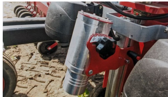
Рис. 6. Встановлена камера на агрегаті для виявлення бур'янів
