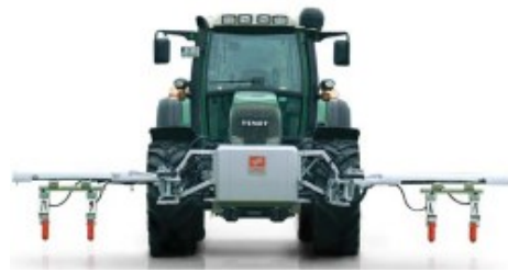
Рис. 4. Сенсор азоту MiniVeg-N
