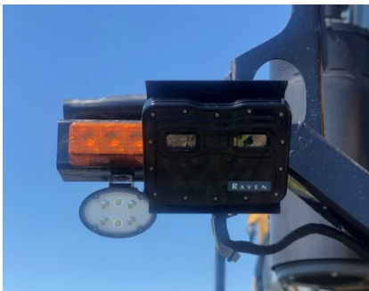
Рис. 8. Камера з двома об'єктивами Raven VSN™
