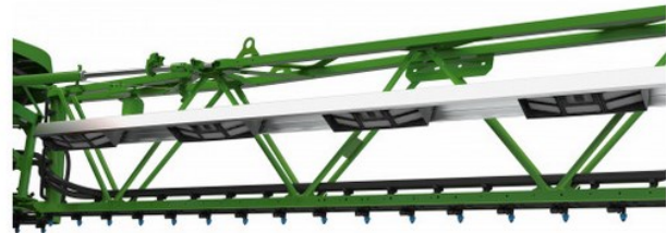
Рис. 11. Система SmartSprayer із встановленими відеокамерами Bosch від Amazone
