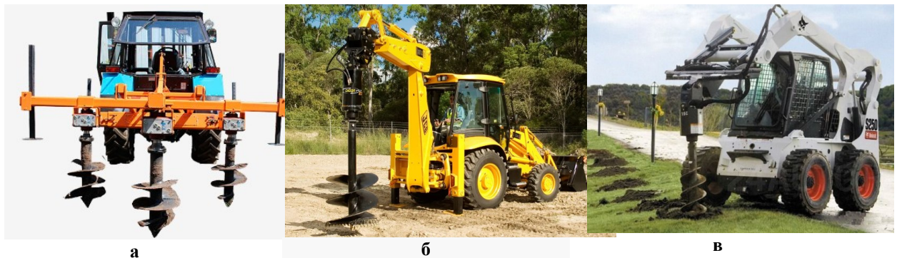
Рис. 3. Обладнання для садіння саджанців плодових дерев: а – ямокопач трьохрядний БАМ-3Х1, б – гідробур Digga PD8, в – гідробур Bobcat
