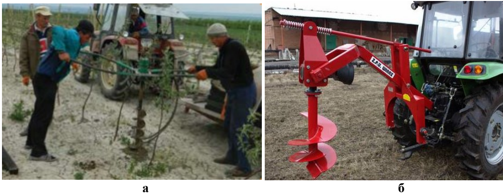
Рис. 1. Обладнання для садіння саджанців плодових дерев: а – ручний ямокопач, б – гідробур
