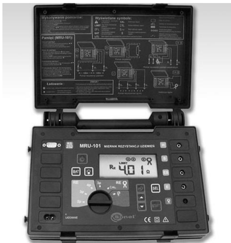
Рисунок 4.1 – MRU-101 Вимірювач опору заземлювальних пристроїв
