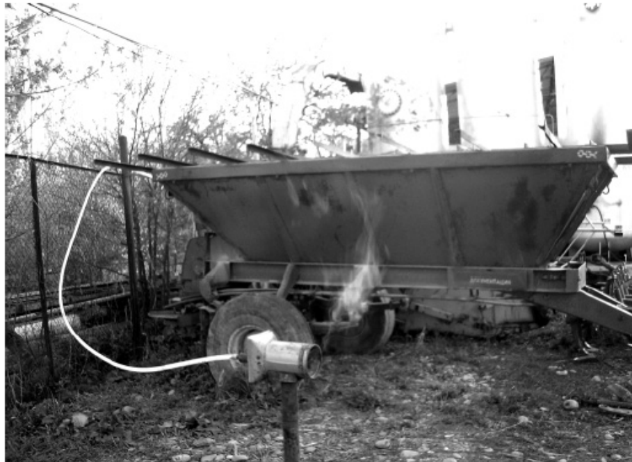
Рис. 7. Факельний пальник для спалювання надлишків біогазу
