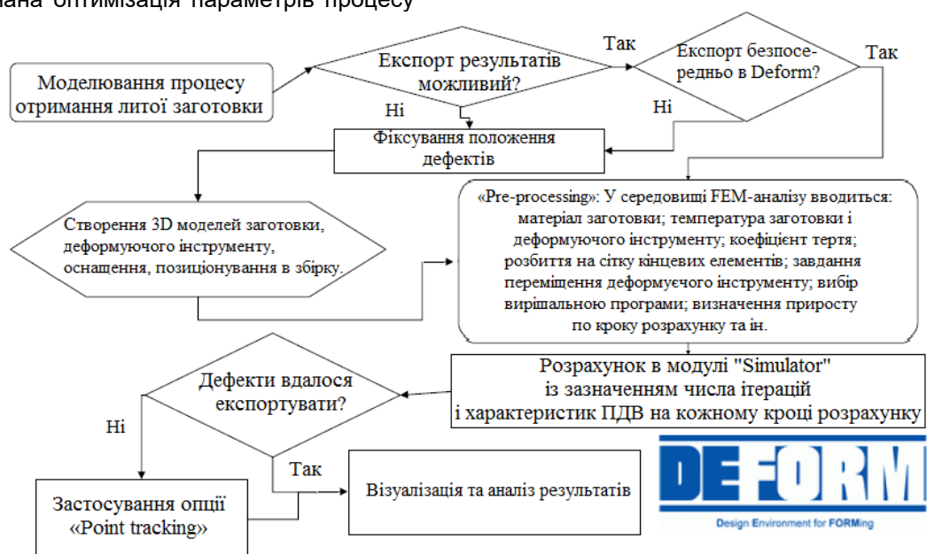
Рис. 1. Алгоритм моделювання наскрізних технологічних процесів виробництва в програмних комплексах скінчено-елементного моделювання типу DEFORM-3D [5].
