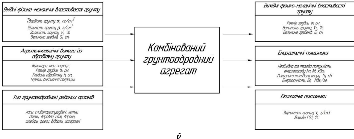
Рис. 2. Блок – схема моделі функціонування комбінованого ґрунтообробного агрегату а – у вигляді вхідних і вихідних сигналів, б – в розшифрованому вигляді
