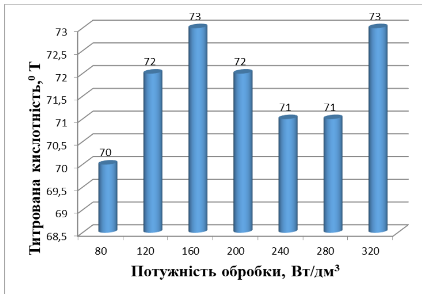
Рис. 1.16. Динаміка титрованої кислотності у зразках молока за тривалості ультразвукової обробки 120 секунд та різної потужності
