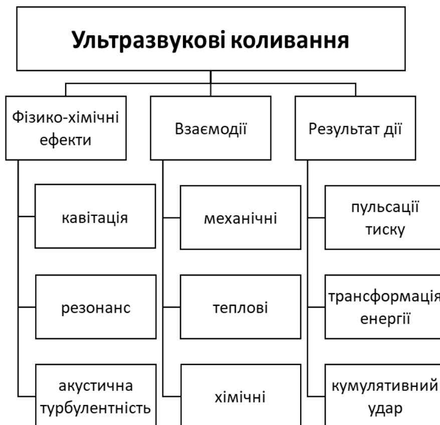
Рис. 1.6. Схема дії акустичних коливань на хіміко-технологічну систему
