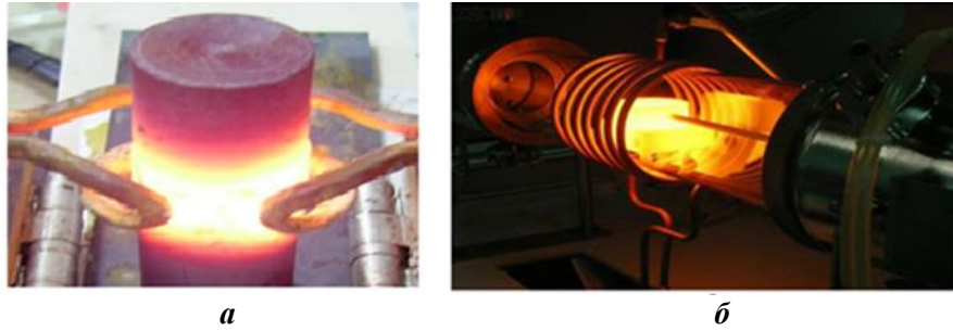
Рис. 3. Вигляд заготовок при нагріванні індукційним електричним полем
