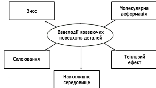
Рис. 2. Схема взаємодій поверхонь ковзання
