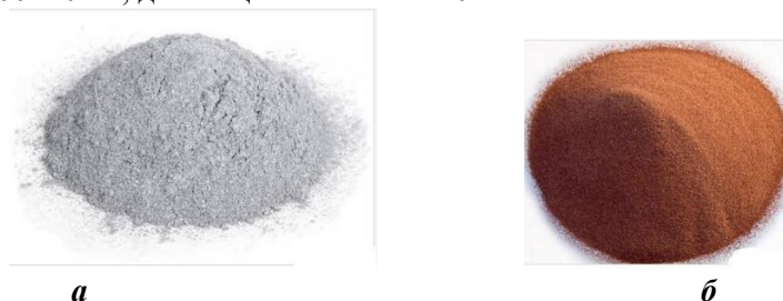
Рис. 7. Фотографії порошоків, що напilenються: а) порошок алюмінію А 30-01, б) порошок міді С01-00
