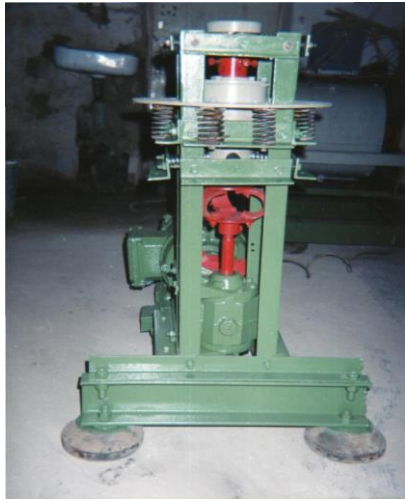
Рис. 1. Фотографії розробленої експериментальної установки вібраційного грохоту та приводного механізму збудження об'ємних коливань.
