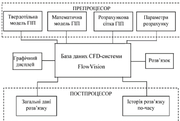
Рис. 4. Типова схема автоматизованої системи розрахунку гідродинамічних процесів в ГПТ гідравлічних ВМ та ВУМ
