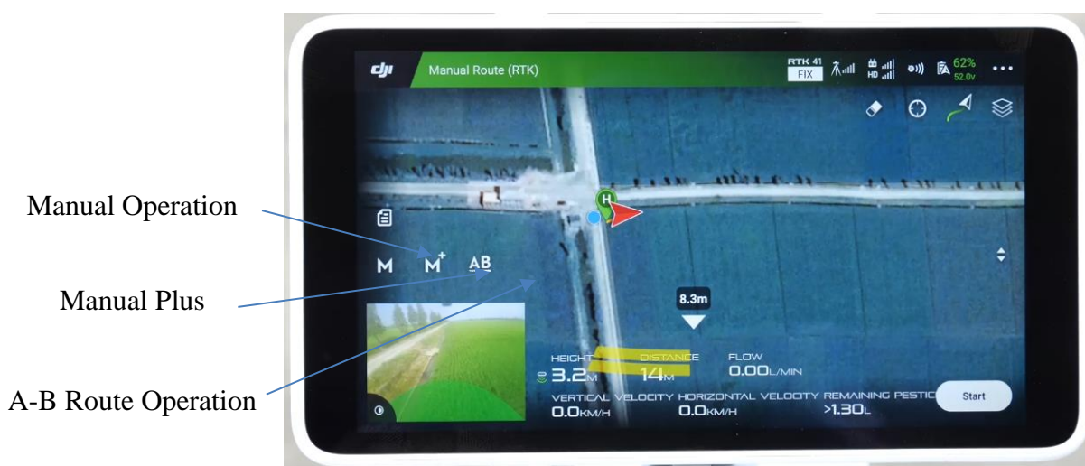
Рисунок 1 – Відображення режимів роботи на пульті дистанційного керування Agras T16
