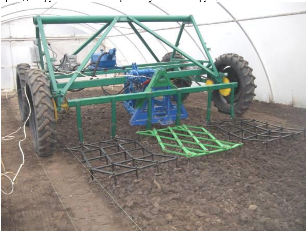
Рис. 4. Лабораторія для випробування мостового агрозасобу нової конструкції з прокладеною постійною технологічною колією
