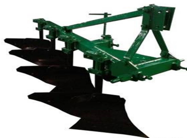
Рис. 2.2. Плуг навісний чотирікорпусний ПН-4-3
