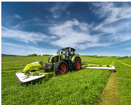
Рис 6.2. Косарка навісна DISCO 2650 (фірма CLAAS)
