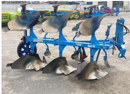
Рис.2.1. Плуг навісний оборотний трикорпусний Lemken OraL 090B
