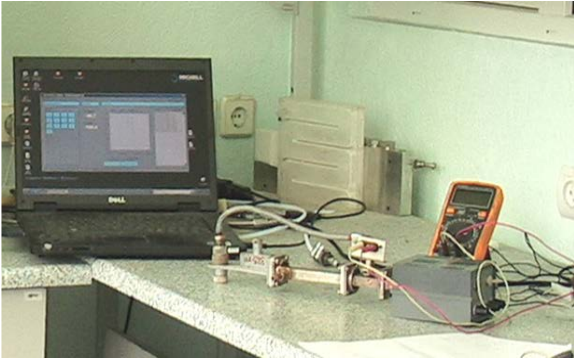
Рис. 6. Зовнішній вигляд засобу вимірювального контролю вологості природного газу та керувального ПК
