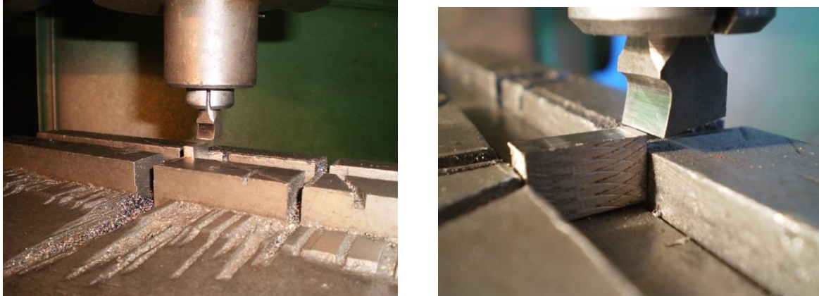
Рис. 7. Процес вільного прямокутного різання.
