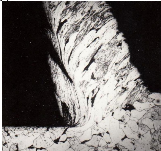
Рис. 9. Мікрофотографія «корня стружки», \times 70 , при вільному ортогональному різанні доєвтиктоїдної сталі на швидкості 10 м/хв. Світлі зерна – ферит, темні – перліт
