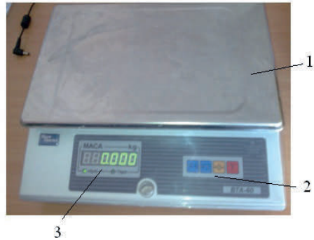
Рис. 2.11. Електронні лабораторні ваги ВТА-60/30-5-Т: 1 – зважувальне деко; 2 – панель керування; 3 – індикаторний дисплей.
