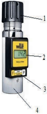
Рис. 2.10. Вологомір Wile-55: 1 – кришка корпусу; 2 – технічний цифровий індикатор; 3 – панель керування; 4 – ємкість для зразка.
