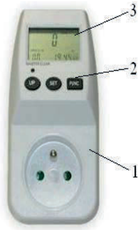
Рис. 2.8. Електронний ватметр EMF-1: 1 – корпус ватметра; 2 – панель керування; 3 – індикаторний дисплей.
