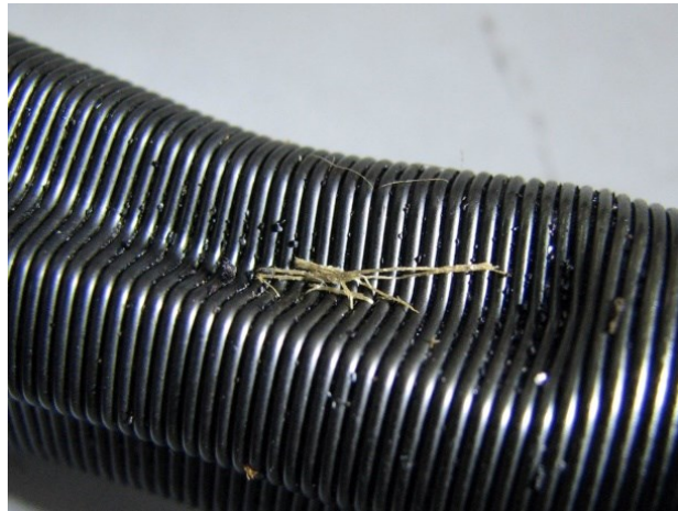
Рис. 2. Деформований фільтраційний елемент фільтра Φ12
