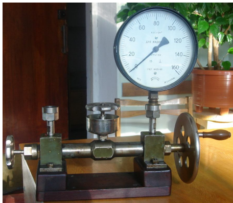
Рисунок Г.5 – Фотографія пресового пристрою для тарування датчиків тиску
