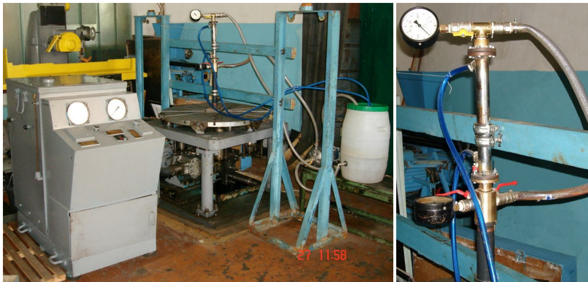
Рисунок 2.3 – Фотографії експериментального стенду з ГП для потокового віброударного фільтрування вологих дисперсних середовищ
