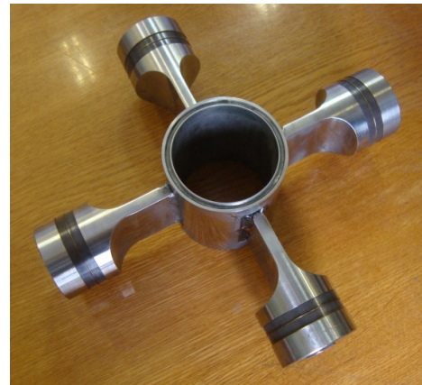
Рис. 2. Трубчастий ультразвуковий кавітатор
