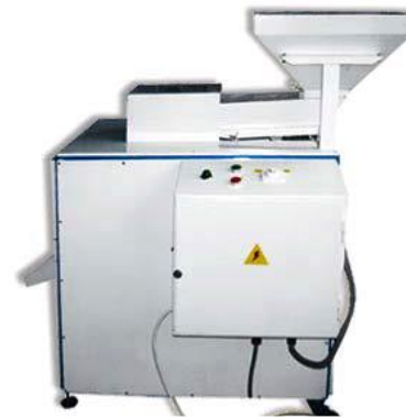
Рис. 3 – Машина для луцення волоських горіхів ОД-1 виробництва фірми «Сервіс-Пак» продуктивністю 50-60 кг/год
