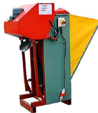
Рис. 4 – Машина для луцення волоських горіхів «Nuts Cracker JUNIOR»
