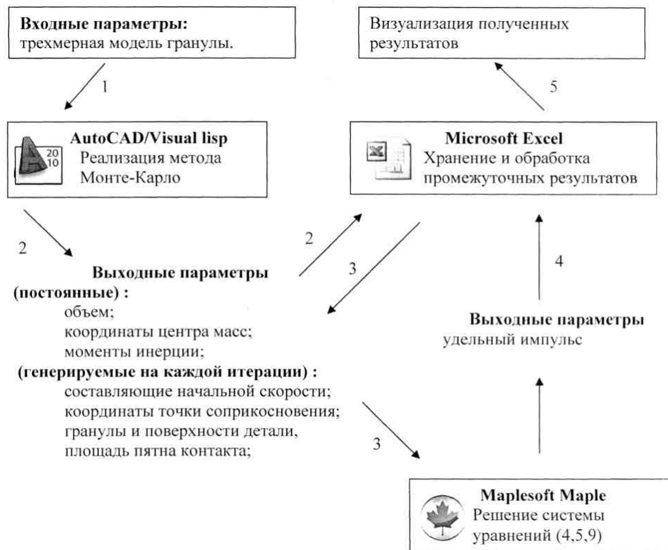
Рис. 2. Принцип взаимодействия компонентов программного комплекса для проектирования и исследования эффективности формы гранулы: 1 – построение гранулы в системе AutoCAD; 2 – передача результатов работы ММК в Excel; 3 – экспорт данных из Excel в Maple для определения удельного импульса; 4 – сохранение данных в Excel; 5 – получение среднего значения, анализ результатов
