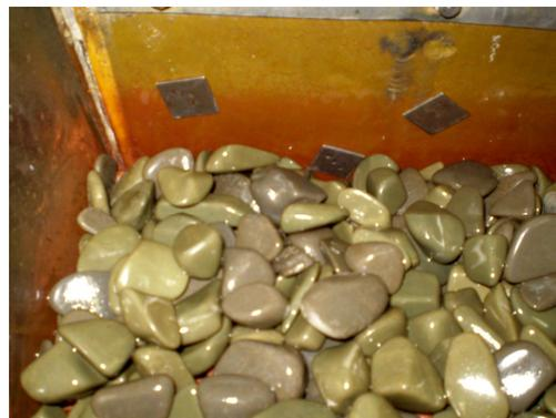
**Рис. 4. Образцы, налипшие на стенках контейнера**
