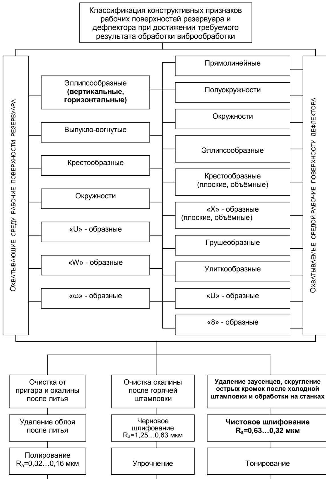
Рис.1. Классификация признаков рабочих поверхностей резервуара и дефлектора
