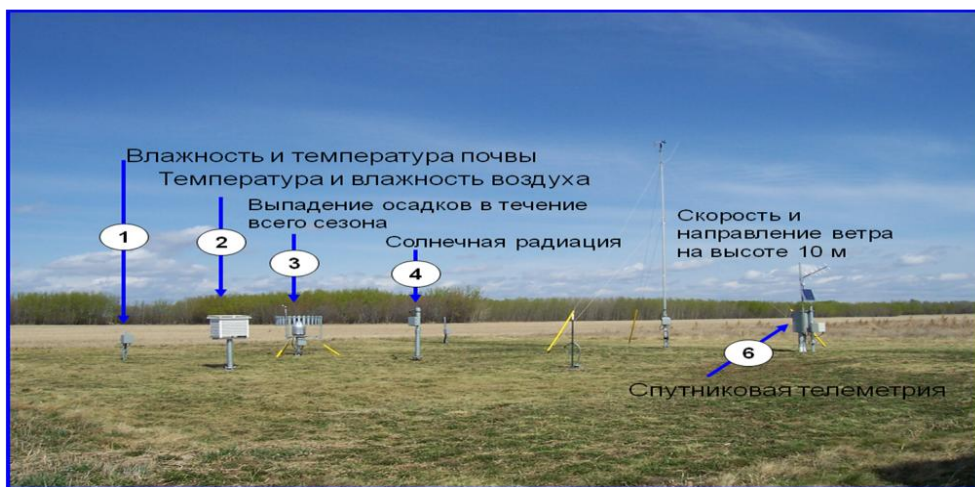
Рис. 5.2. Параметри, що вимірюються метеостанціями останнього покоління (Джерело: Міністерство сільського господарства і розвитку провінції Альберта)
