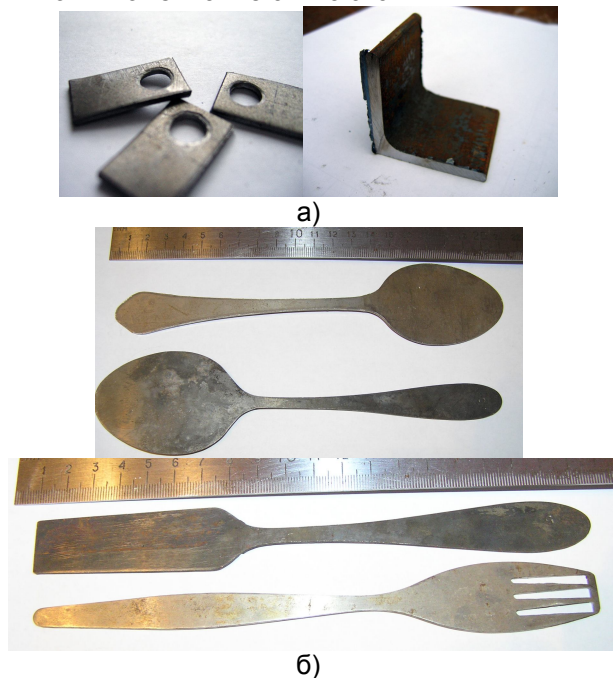
Рис. 2. Детали, склонные к слипанию в пакеты: а) пластики и уголки; б) заготовки ложек и вилок
