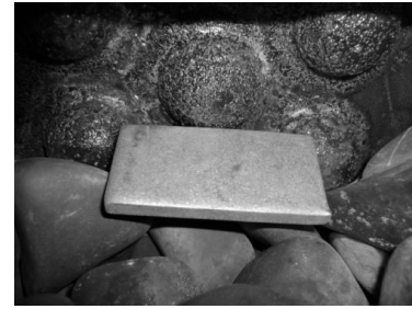
Рис. 10. Плоский образец, застрявший между выступами футеровки
