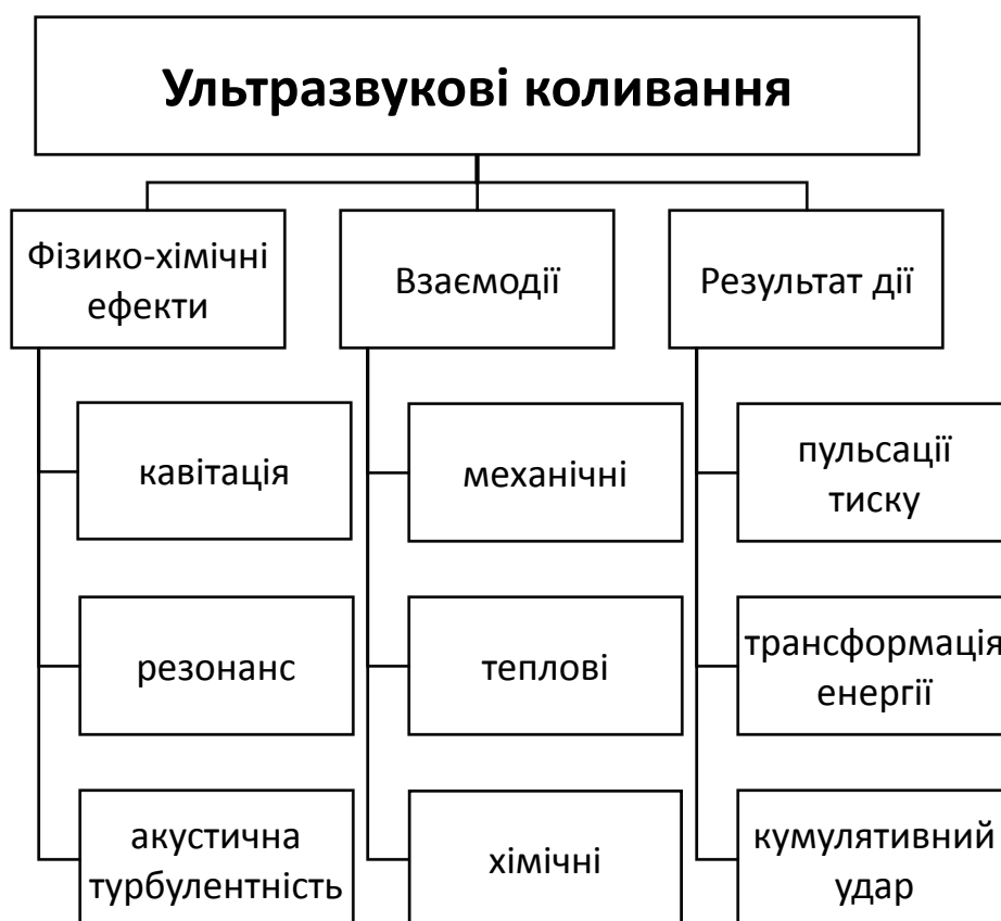
Рис. 3. Схема дії акустичних коливань на хіміко-технологічну систему
