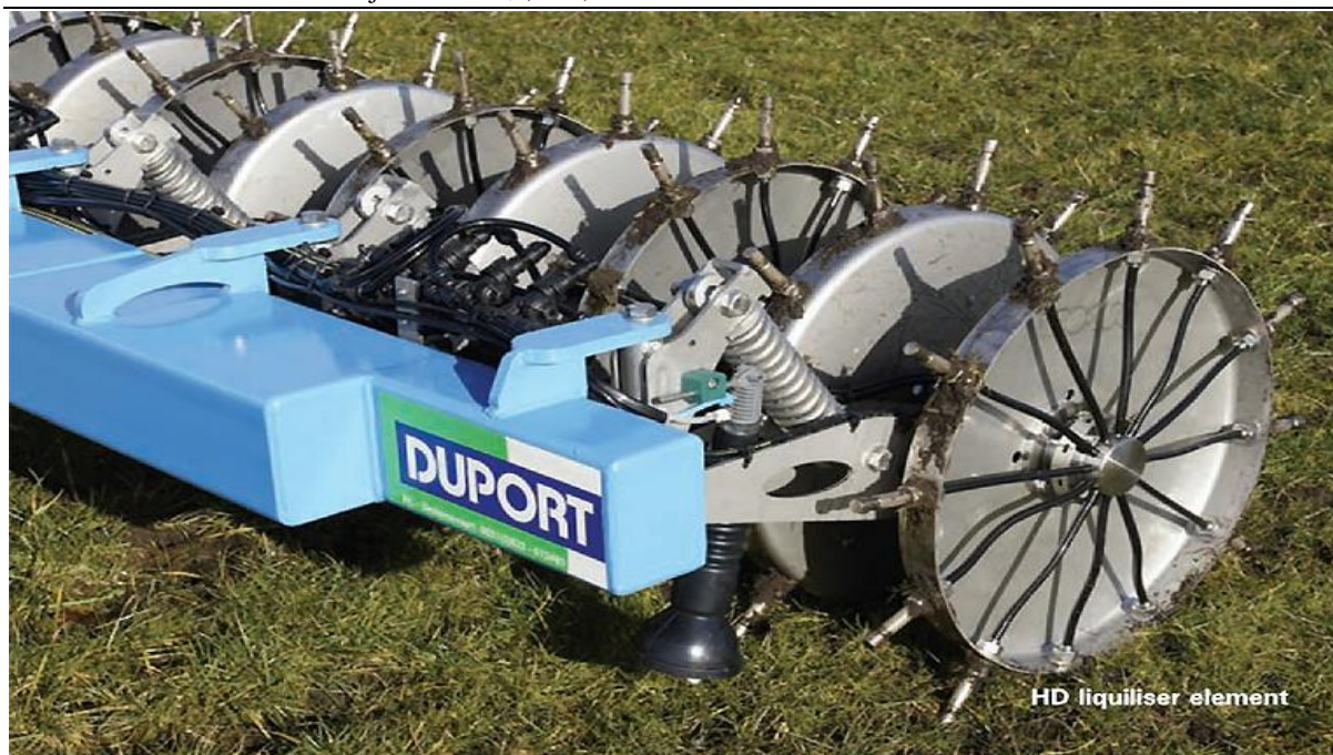
Рис. 2. Секція американської інжекторної системи SpikeWheel
