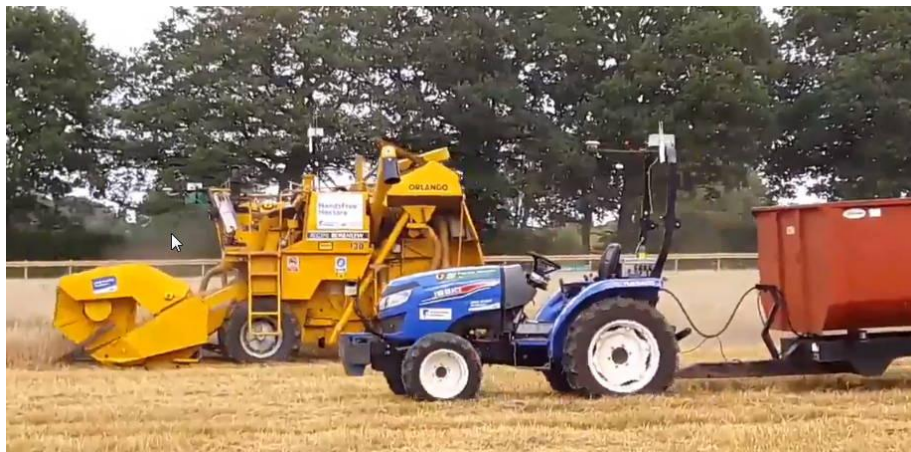
Рис.3. Модифікований трактор та комбайн під керуванням камер, лазерів і GPS-систем
