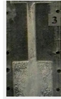
Рис. 6. Зрив газової порожнини та виникнення процесу гідродинамічної кавітації
