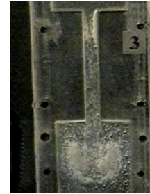
Рис. 4. Кавітаційний обертальний кластер, який утворюється при гідрокавітації у вібраційній установці на основі гідропульсатора
