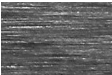
Рис. 4. Образец после вибрационного шлифования и полирования
