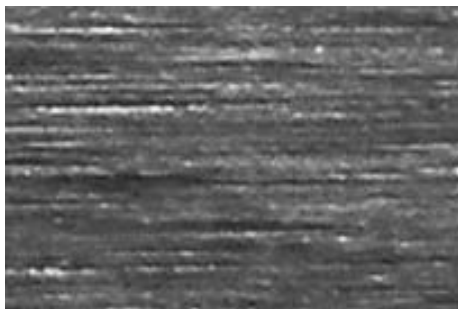
Рис. 2. Образец после традиционного шлифования
