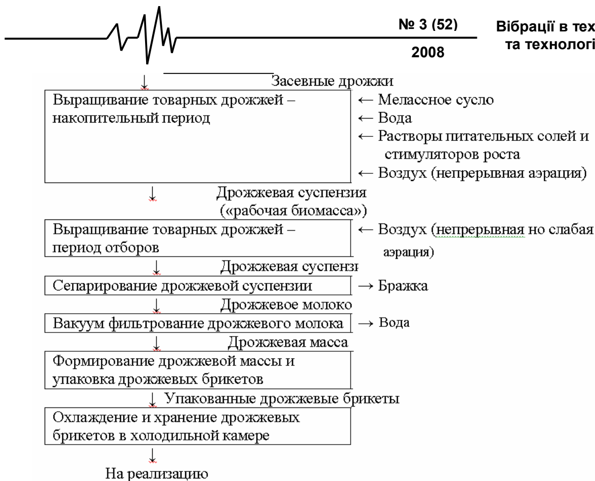
Рисунок 1. Принципиальная технологическая схема выращивания и выделения товарных дрожжей с последующей их обработкой
