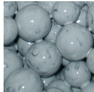
Рис. 5. Стеклянные шары диаметром 5 и 10 мм с поверхностной пленкой рабочего раствора и зернами цинка в местах контакта между собой
