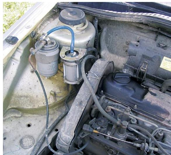
Рис. 2. Размещение ММТ в подкапотном пространстве автомобиля VOLKSWAGEN GOLF
