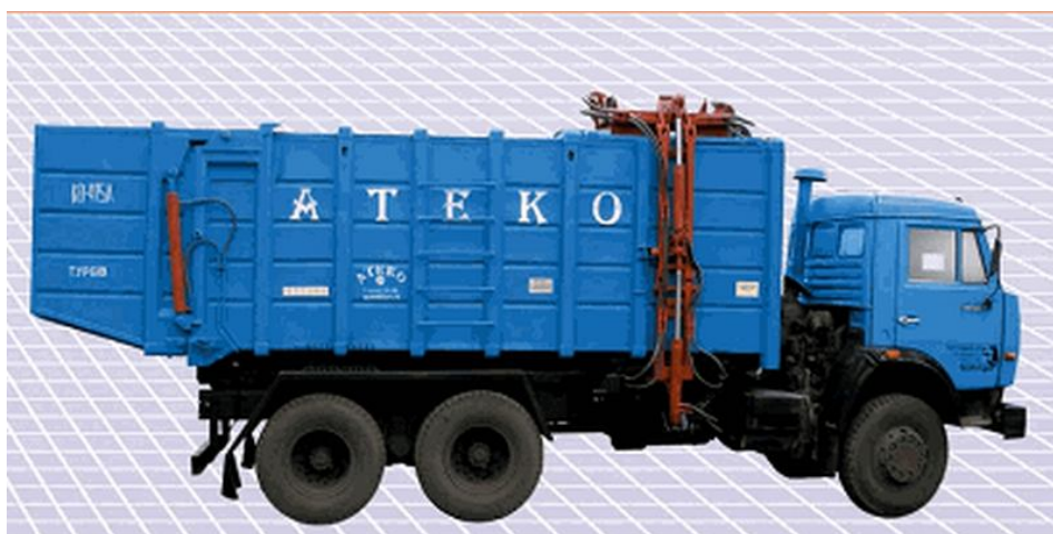
Рис3. - Сміттєвоз марки КО – 415 А з боковим завантаження за допомогою маніпулятора.
