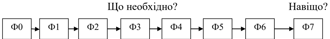
Рис. 5.7 – Функціональна модель процесу формоутворення Ф0 – навішування; Ф1 – спосіб ВУП; Ф2 – режим ВУП; Ф3 – функціонування ГП; Ф4 – функціонування рухомих ланок ІВПМ; Ф5 – функціонування віброзбуджувача; Ф6 – функціонування прес-форми; Ф7 – заготовка
